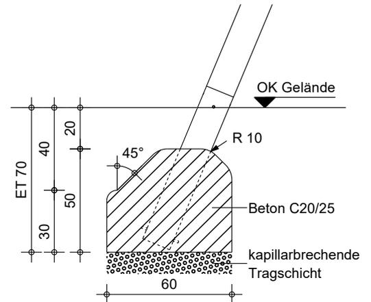
**Bei Robinienhölzern verändern sich Maßangaben. Fundamentlöcher müssen entsprechend nachgestochen und die Aufprallfläche evtl. angepasst werden. Die angegebenen Sicherheitsabstände (siehe Pfeile) müssen ab der tatsächlichen Geräteaußenkante eingemessen werden!**
