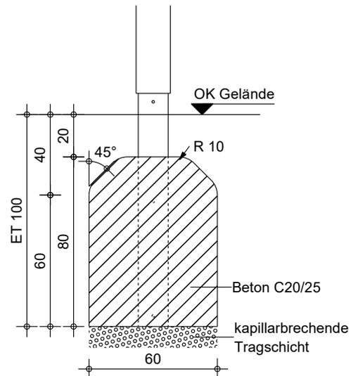
**Bei Robinienhölzern verändern sich Maßangaben. Fundamentlöcher müssen entsprechend nachgestochen und die Aufprallfläche evtl. angepasst werden. Die angegebenen Sicherheitsabstände müssen ab der tatsächlichen Geräteaußenkante eingemessen werden!**
